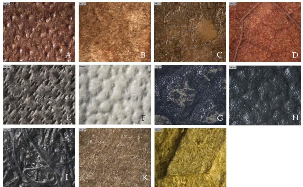
Figure 3. Surfaces des matériaux étudiés : Matériaux naturels (Cuir (A), Muskin® (B), Kombucha (C), Teak Leaf® (D)) ; surfaces gaufrées de textiles enduits (textile enduit de PUR (E), Desserto® (F), Appleskin® (G), Vegea® (H)) ; structures fibreuses en fibres naturelles non tissées (Pinatex® (I), SnapPap® (K)), et un matériau en microfibres (Noani® (L), gaufré).
